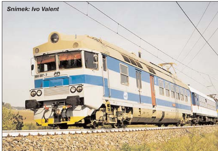
První vozidlo ČD s prvky IGCT - elektrický vůz 560.007 (při trakčních zkouškách na ŽZO dne 27. 4. 2004).
